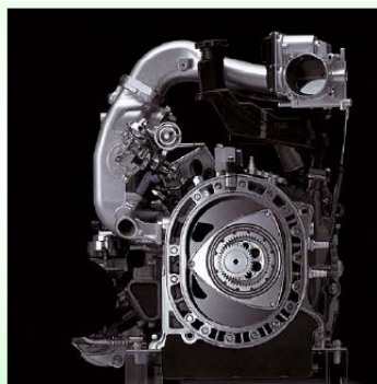
Mazda Renesis (Bi-Fuel, 2 Scheiben à 650ccm, 110PS mit H 2 , 220PS mit Benzin)
